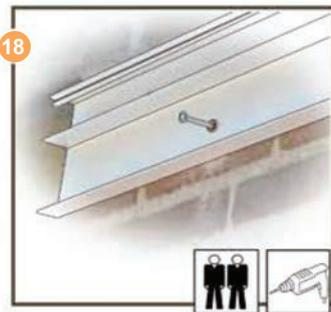
18 Houd het muurprofiel tegen de muur. (2 personen) Controleer of het muurprofiel waterpas is geplaatst. Boor de bevestigingsgaten in de muur voor, om de 750 mm.
