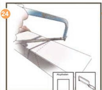
Alupfosten zurechtsägen. Schritt 14 für den zweiten Alupfosten wiederholen. Sägen Sie den zweiten Alupfosten auf die richtige Länge.
