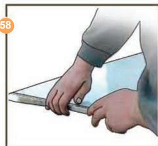
Plak op de muurzijde van de platen de aluminium tape.
