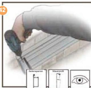
Schrauben Sie das Aussenteil auf dem Mauerprofil fest.
