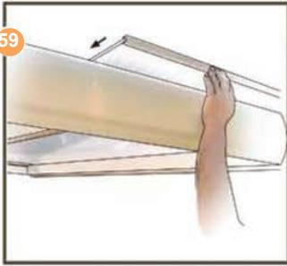
59 Platten auf die Seiten- und Zwischenpfosten legen. Das Alu Kondensprofil muß an der Rinnenseite liegen; mit der Lippe an der Unterseite. Die Platten müssen mindestens 20 mm Spiel pro Meter haben, da diese sich unter Einfluß von Wärme ausdehnen.
