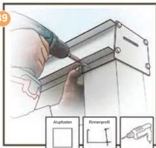
Legen Sie die Rinne auf den Pfosten und stellen Sie sicher, dass sich dieser im Blei befindet. Schrauben Sie die Rinne mit 2 Schrauben mit Abdeckkappe auf dem Pfosten fest. Drücken Sie die Abdeckkappen auf die Schrauben.
