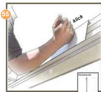
Klicken Sie die Blende auf das Mauerprofil. Wiederholen Sie diese Schritte bis das Mauerprofil mit der Klickleiste versehen ist. (Optional gilt das Gleiche für das Rinnenprofil)
