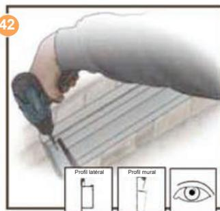
Fixez le profil latéral sur le profil mural avec une vis autotaraudeuse.
