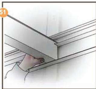
Wiederholen Sie jeden Schritt bis alle Mittelsparren und Zwischenpfosten gesetzt sind.
