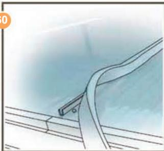
60 Enfoncez le caoutchouc de toiture dans les profils intermédiaires. Laissez la dernière pièce ouverte au niveau de la goutlotte.
