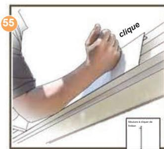
Cliquez la moulure à cliquer de finition sur le profil mural. Répétez les différentes étapes jusqu'à ce que le profil mural soit doté de moulures à cliquer de finition.
