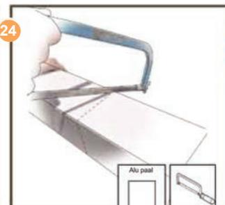
24 Zaag de alu paal af. Herhaal stap 14 voor de tweede alu paal. Zaag de tweede alu paal op de goede lengte af.
