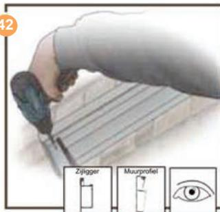
Schroef de zijligger op het grootprofiel vast met een zelftap schroef. Indien nodig voorboren met een 3 mm boor.
